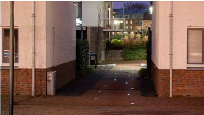
Lichtspots in de bestrating markeren een plek. In het geval van de Romkessteeg wordt de entree van de steeg geaccentueerd. De verlichting wordt in de looper opgenomen. Foto: IPV Delft
