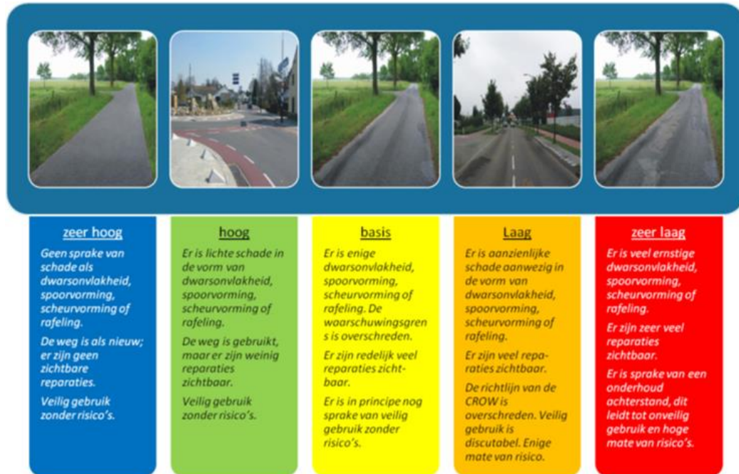
Figuur 2.2.1 Meetlat asfaltverharding
