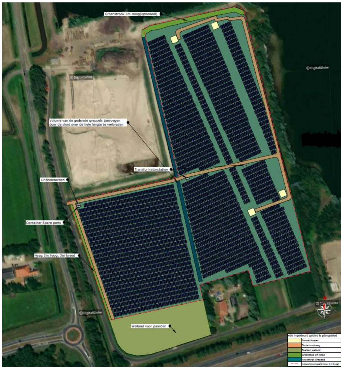
Fig. 6: Ontwerp en inpassing met verklaring der kleuren. Verschil in richting van de panelenrijen is duidelijk te zien: haaks op sloten in westelijk deel, haaks op hoogspanningsleidingen in oostelijk deel. Plaatsing van transformatorhuizen is duidelijk aangegeven (langs onderhoudsweg).
